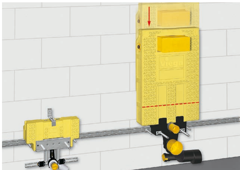
2 – 87 ábra. Mono-blokkok – sínes szerelés
