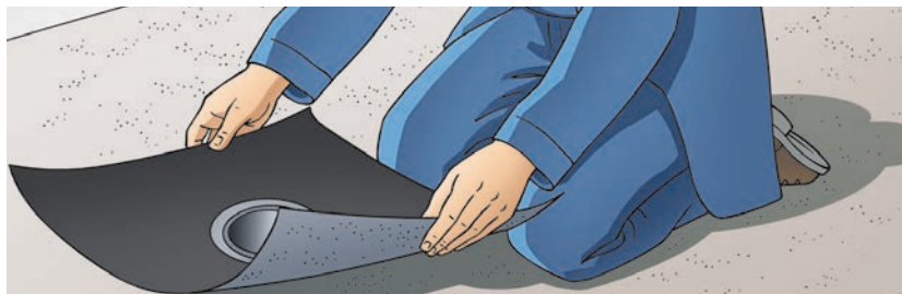
3 – 19 ábra. A tömítőgallér elhelyezése
